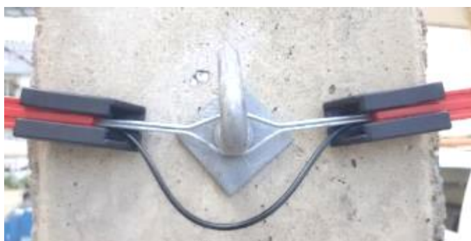
ภาพประกอบที่ 15. ติดตั้งอุปกรณ์จับยึดสายกระจายแนวตรง Nylon-6/ABS ในสนามทดลอง
