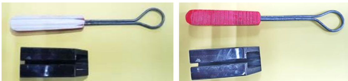
ภาพประกอบที่ 10. ต้นแบบอุปกรณ์จับยึดสายกระจายแนวตรงผลิตจากแท่งพลาสติกเชื่อมกาว
