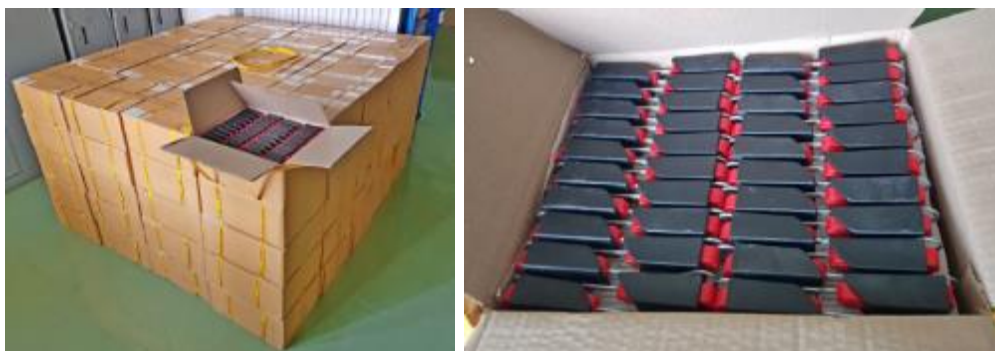
ภาพประกอบที่ 14. สั่งผลิตต้นแบบอุปกรณ์จับยึดสายกระจายแนวตรง Nylon-6/ABS
