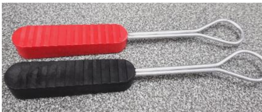
ภาพประกอบที่ 18. เปรียบเทียบวัสดุผลิตแกนกลางต้นจาก ABS (แดง) และ Nylon-6 (ดำ)
