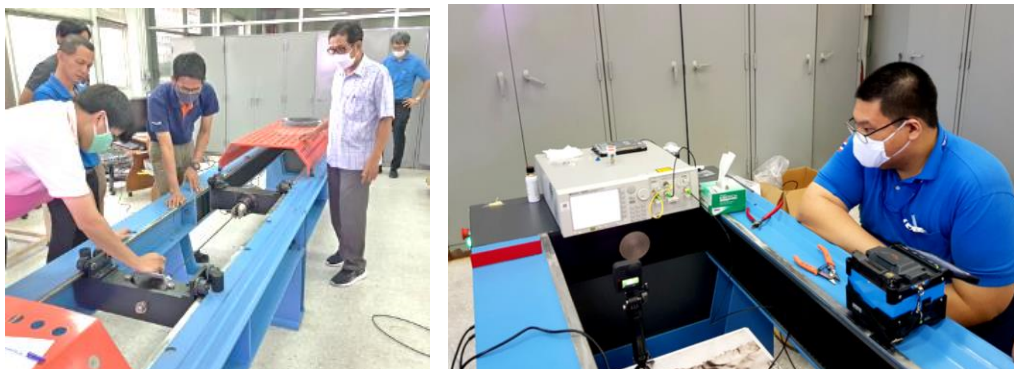
ภาพประกอบที่ 6. ทดสอบการรับแรงดึงสาย Access OFC LSZH และป้อนสัญญาณแสงวัดค่า Loss ตลอดการทดสอบ
